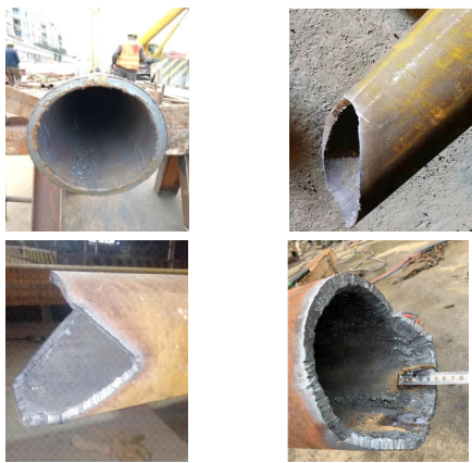
图 7 不同管棚前端结构形式
