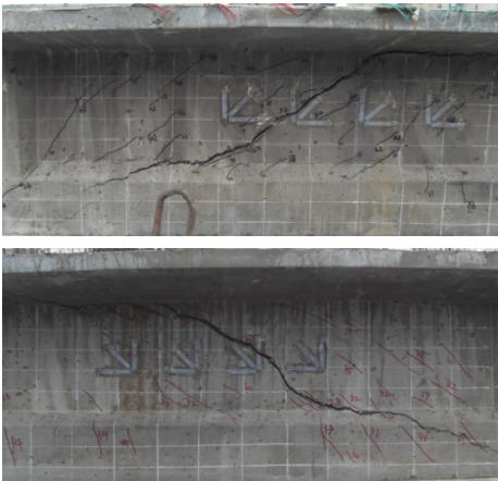
图 5 试验梁典型破坏图
