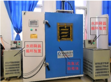
图 1 土工冻胀试验机
