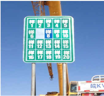
图7 室外试验现场安装图
