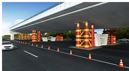
图10 金丰高架桥顶升施工示意图
