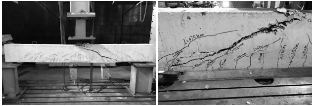
图 1 试验梁破坏形态
