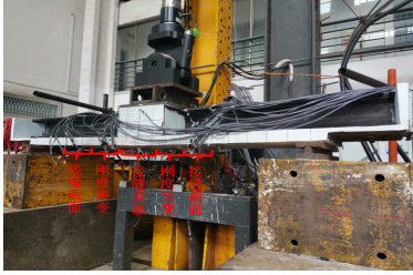
图 15 横向接缝负弯矩试验
