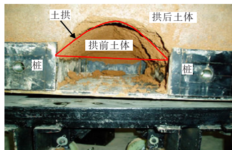
图1 拱前土体滑塌试验
