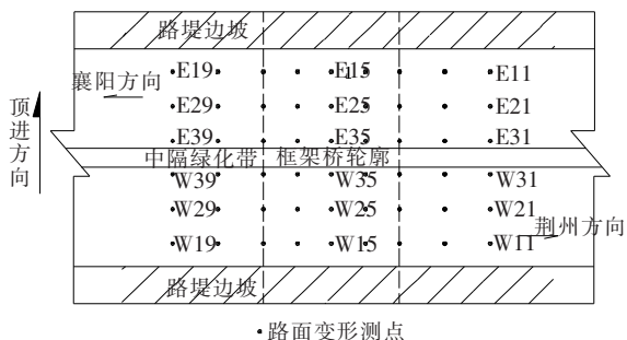
图 8 路面变形测点示意图
