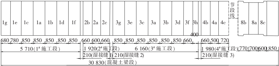
图 6 箱梁节段浇筑示意(单位:cm)
