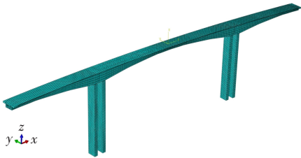
图 4 桥梁结构有限元模型
