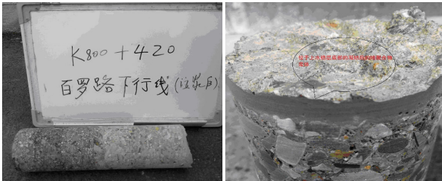
图 2 注浆后钻芯在上下层层间发现 6~10 mm 厚注浆结石 (K800+420 慢车道,两层注浆工艺,钻孔深 35 cm)
