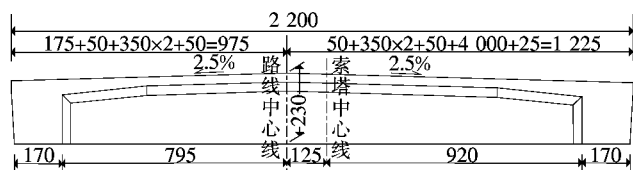
图3 主梁标准横断面图(单位:cm)
