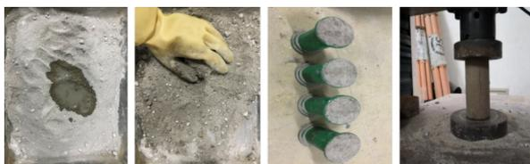
(a) 原材料准备 (b) 原材料搅拌 (c) 模具装填 (d) 试件抗压试验
