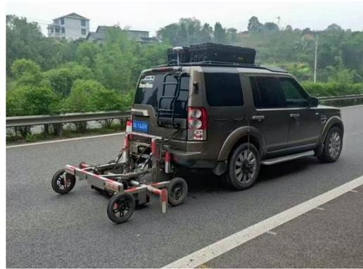
图16 探地雷达技术在路面监测中的应用
