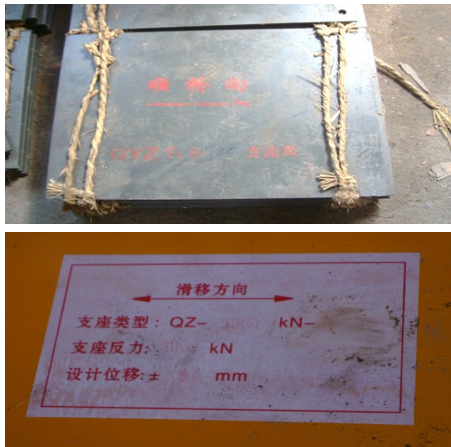
图6 支座厂家滑动方向标注错误
