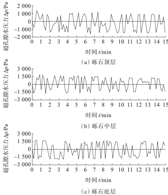
图3 砾石层不同深度处超孔隙水压力随时间的变化
