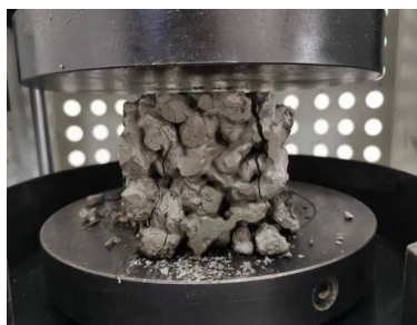
图 14 普通骨料混凝土
