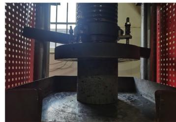
图10 无侧限抗压强度测试
