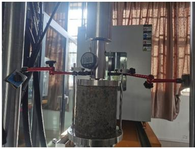
图 13 抗压回弹模量测试
