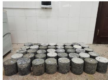
图11 测试后的部分试件
