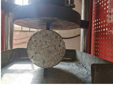
图 12 劈裂强度测试
