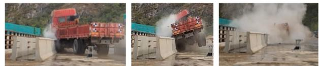
(a) 大型货车碰撞无种植土优化型混凝土护栏过程
