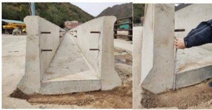
图 12 建设的试验护栏
