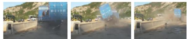
(b) 大型货车碰撞有种植土混凝土护栏过程
