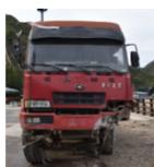
(c) 大型货车碰撞后车辆损坏
