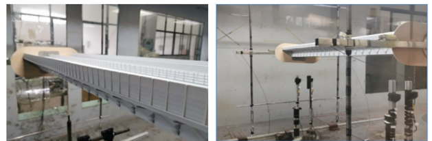
图11 节段模型风洞试验
