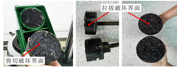
图 4 剪切与拉拔破坏界面形态
