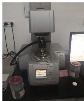
图1 蠕变试验装置
