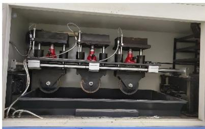
图3 车轮跟踪试验仪
