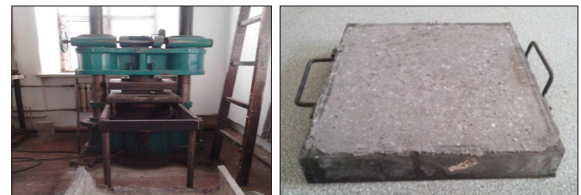
图4 静压成型试件
