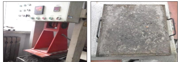
图3 碾压成型试件
