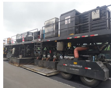
图3 Ecoheater Kaph 8 sp加热机
