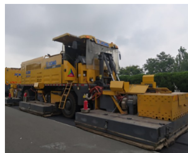
图4 徐工热风加热机
