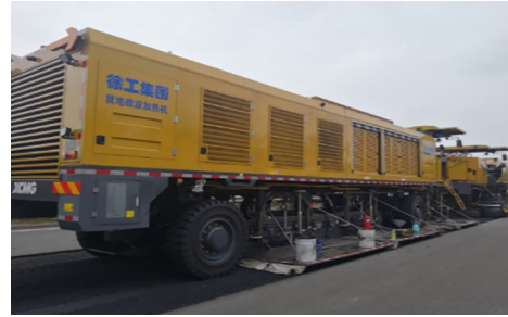
图7 料垄微波加热
