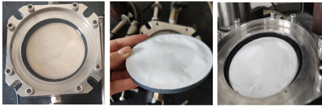
(a) 陶土板底座 (b) 纤维薄膜与致密透水石 (c) 纤维薄膜底座
