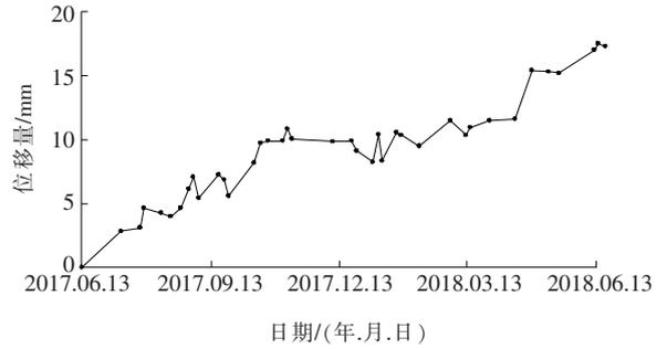
图7 SZ1监测孔朝渣场下游5.5 m深度处位移-时间曲线
