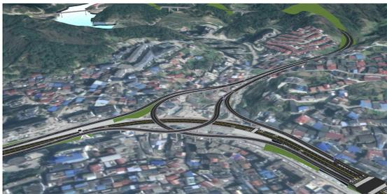
图 5 推荐方案 Y 形互通三维模型(凤湾桥段)
