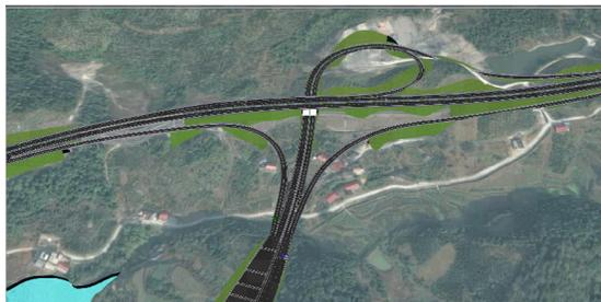
图 4 推荐方案单喇叭互通三维模型
