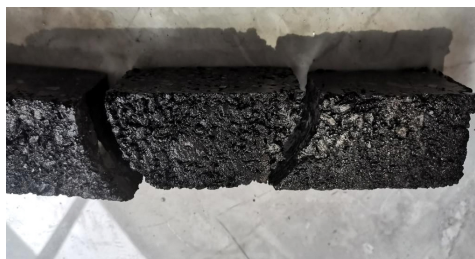
图6 热拌沥青混合料修补切开结果
